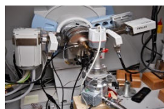
Konfigurace pro měření vysokoteplotních fázových transformací
